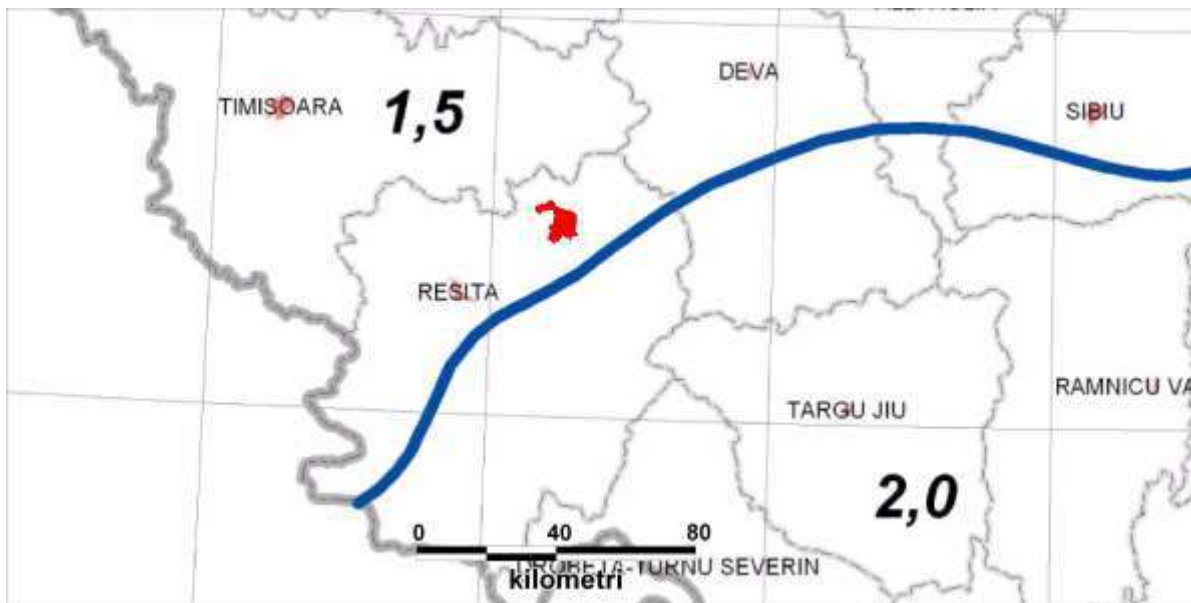
Figura – Evaluarea acțiunii zăpezii asupra construcțiilor
